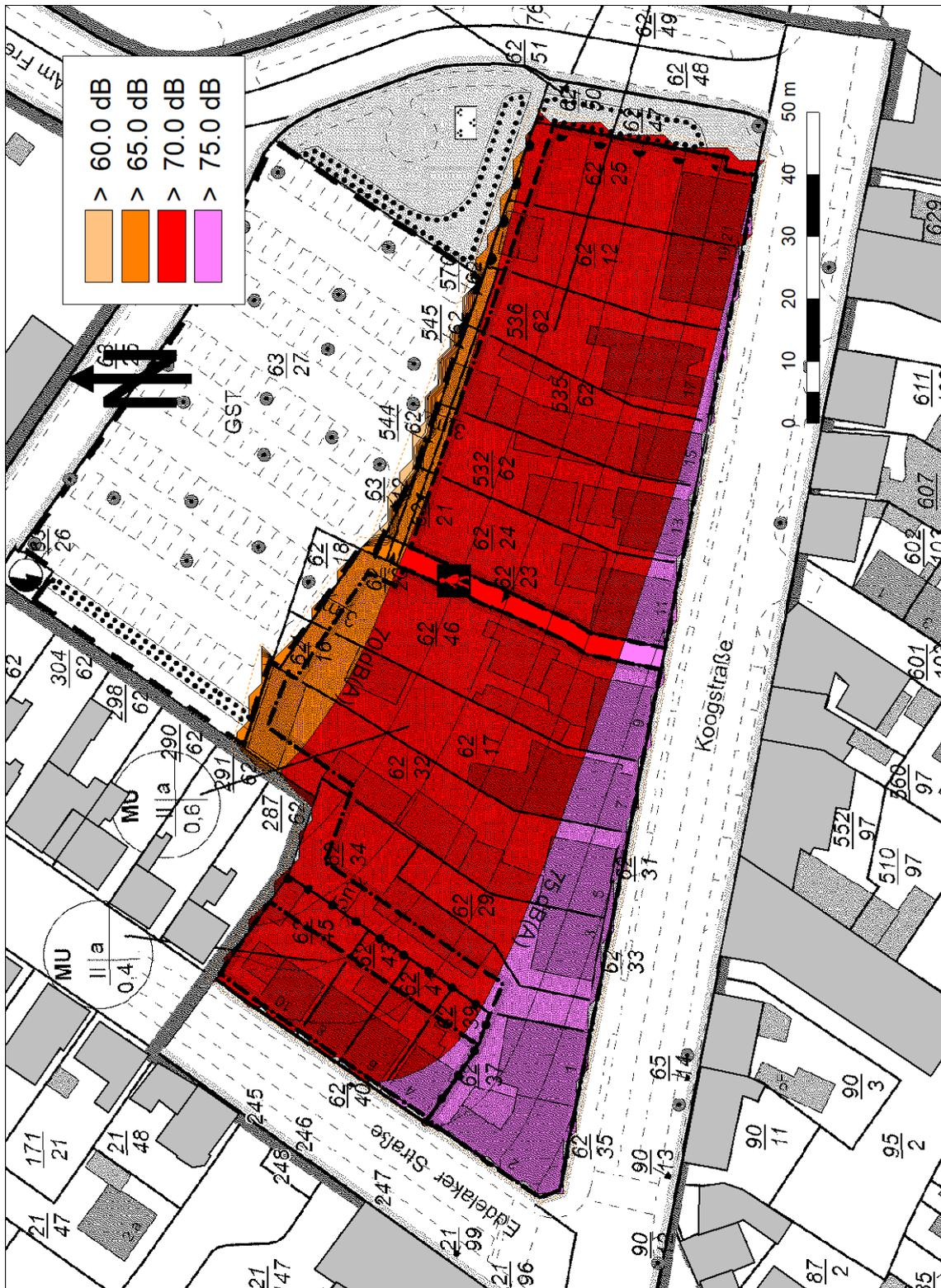
Hierbei ist darauf hinzuweisen, dass bei einem maßgeblichen Außenlärmpegel von größer 70 dB(A) mit erheblichem passivem Schallschutz und damit zusätzlichen Baukosten zu rechnen ist.
