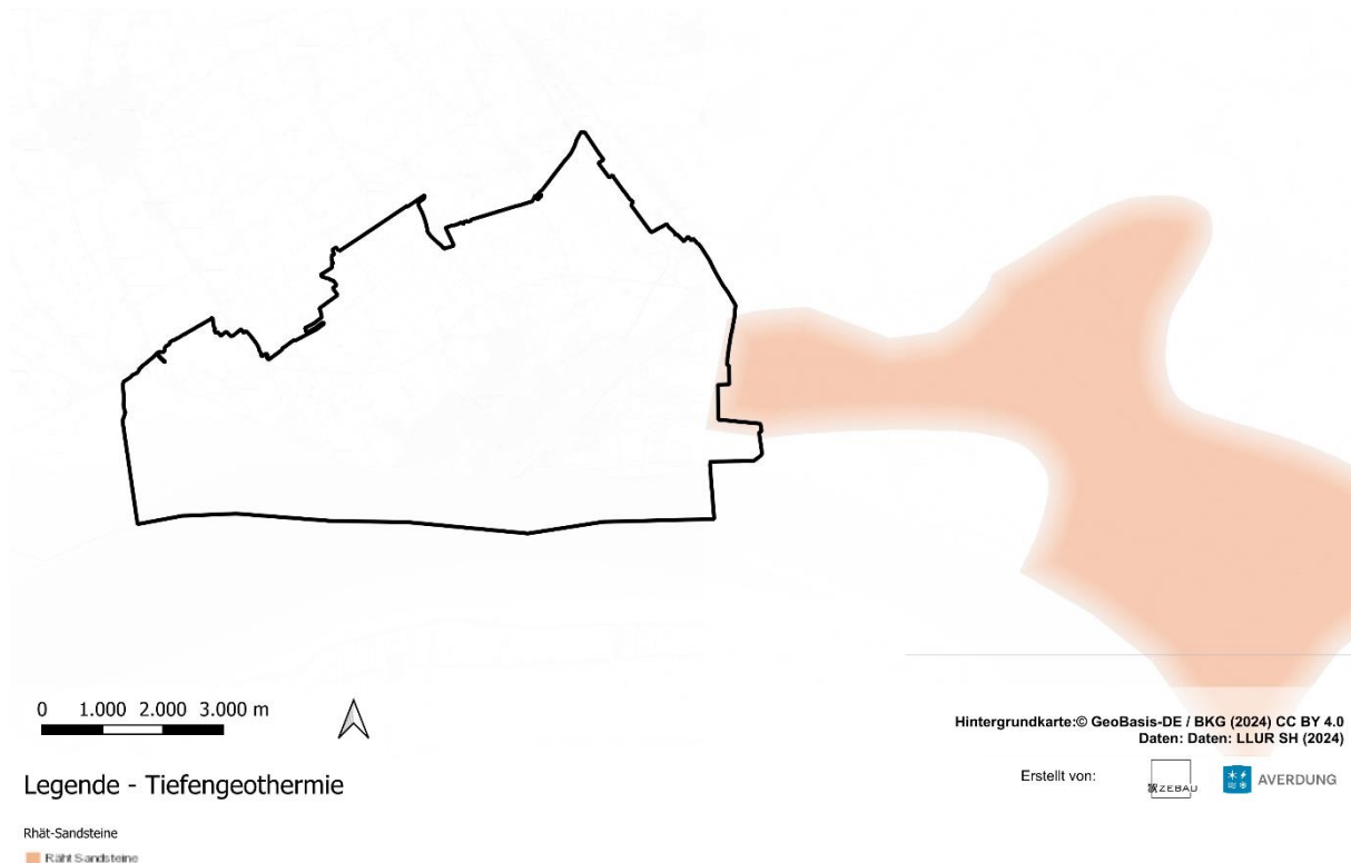
Abbildung 23: Potenziale für Tiefengeothermie in Rhät-Sandsteinen bis 2.500 m Tiefe
