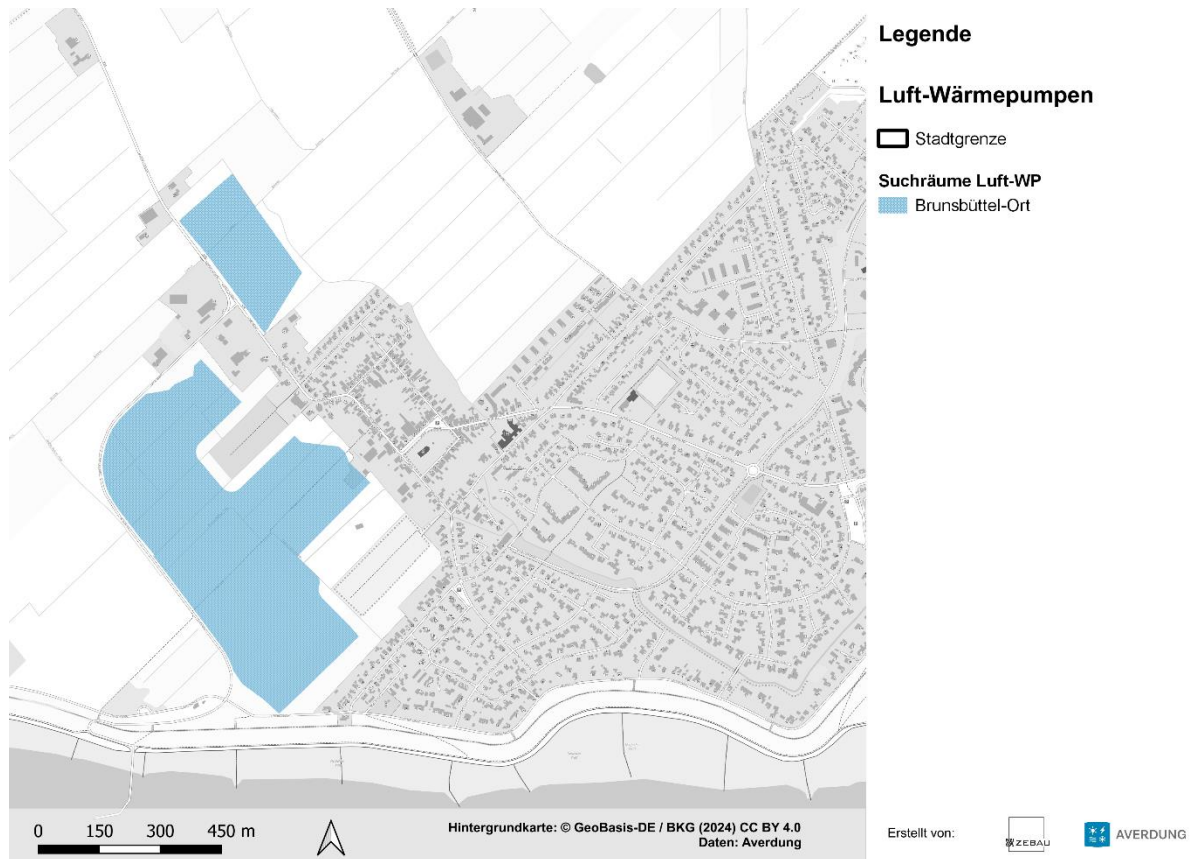
Abbildung 30: Suchräume für Standorte von Luft-Wärmepumpen in Brunsbüttel-Ort
