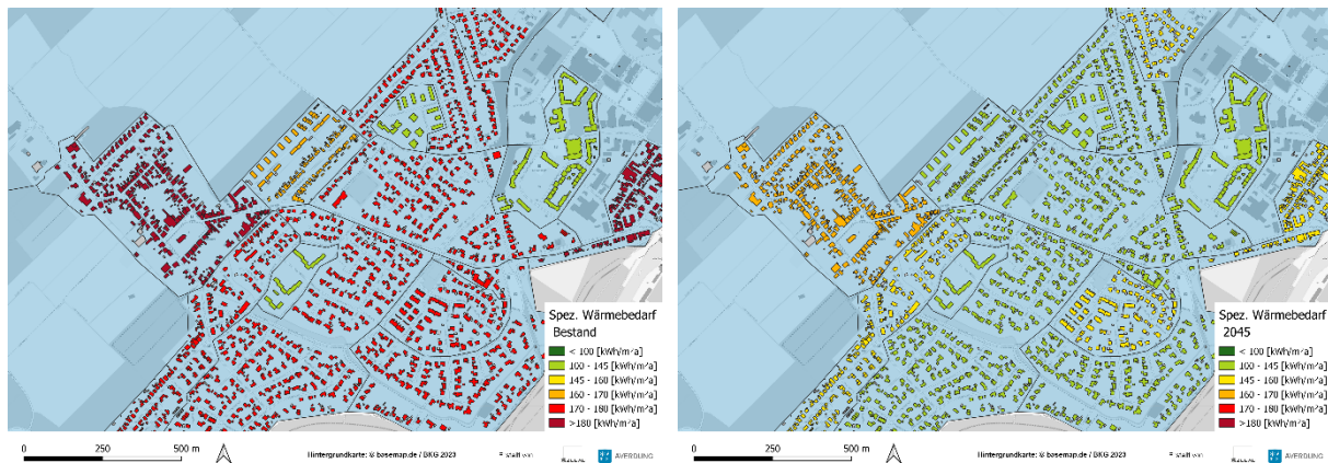
Abbildung 21: Ausschnitt Reduktion spezifische Wärmebedarfe Bestand (l.) zu 2045 (r.)
